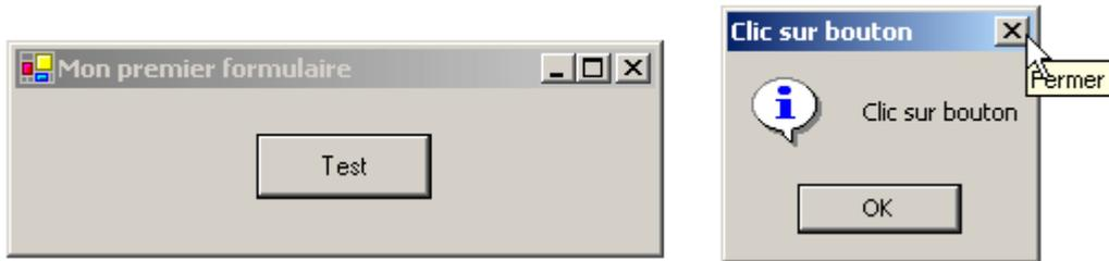
La classe *MessageBox* sert à afficher des messages dans une fenêtre. Nous avons utilisé ici le constructeur
